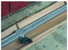
Facilita la colocación de tejas con exactitud en la medida de superposición entre ellas.
