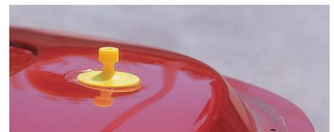
Las ventosas amarillas son rígidas, permiten soportar mayores cargas para la extracción de golpes
