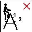
No utilizar los dos peldaños o escalones superiores, sin plataforma o dispositivo de agarre, como superficie de apoyo.
