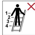
No ascender los cuatro peldaños superiores del producto en posición "escalera de tijera con tramo extensible" o en posición "de apoyo" (siempre que sean existentes).
