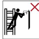
Evitar los trabajos que originen una carga lateral (p.ej., perforación lateral de materiales sólidos).
