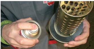
**2** Lubricar la junta del antirrobo para facilitar su instalación.
