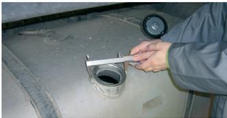
**1** Comprobar el diámetro exterior del gollete del depósito de combustible.
