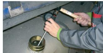
**5** Doblar las pestañas de sujeción con un destornillador y un martillo.
