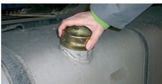
**3** Introducción del antirrobo en el tanque y realizar un primer apriete con la mano.
