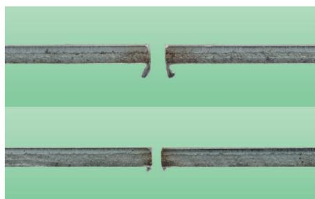
Detalle del corte con disco de 1 mm comparado con el de 0,8 mm. Corte más rápido y preciso con menos rebabas
